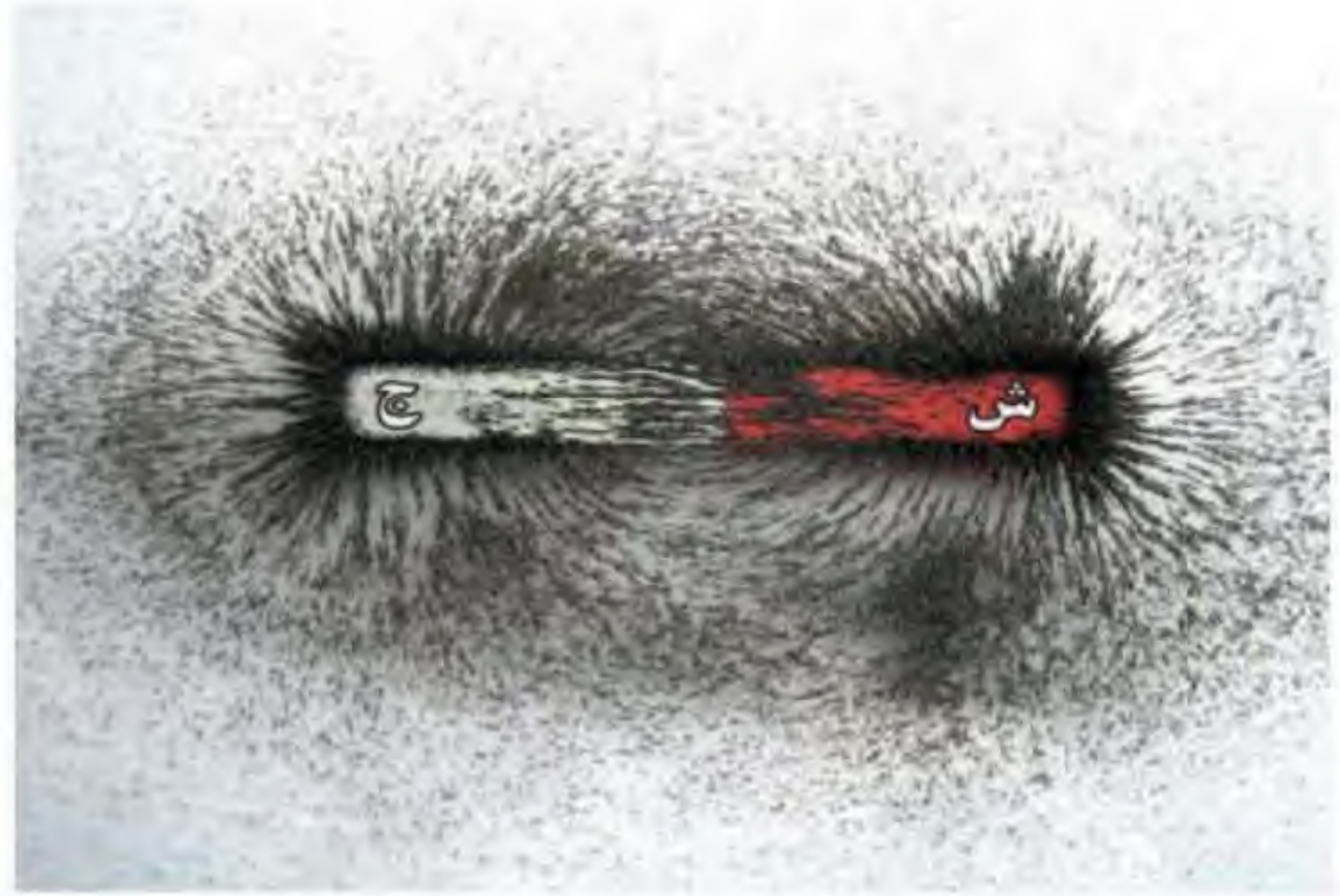
تساعد برادة الحديد على إظهار خطوط المجال المغناطيسي حول قضيب مغناطيسي.
