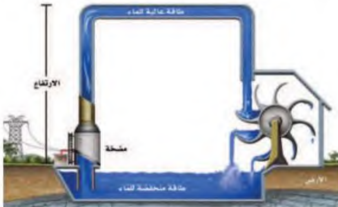
الشكل ٥ تزداد طاقة وضع الجاذبية للأرضية للماء عند رفعه فوق سطح الأرض باستخدام المضخة.
